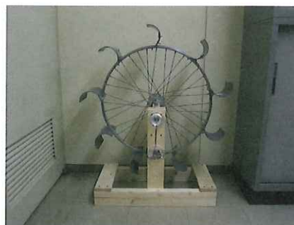
図4 雨水力発電機
